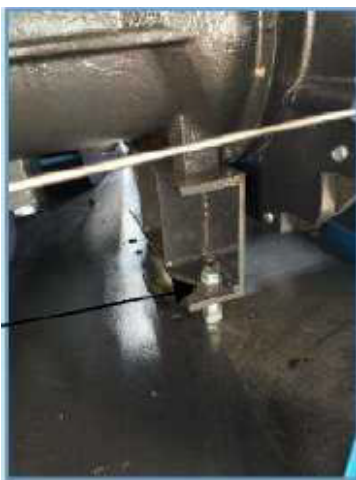
Рисунок 8.2 Гвинт кріплення для транспортування
