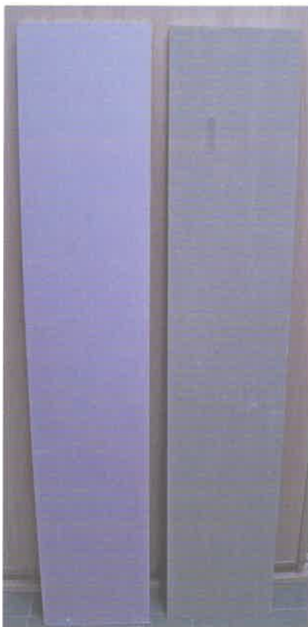
Рисунок 1 - Зовнішній вигляд зразка плити гіпсокартонної типу «DF», що виробляється ТОВ „КНАУФ Гіпс Київ”, які були надані для випробувань.
