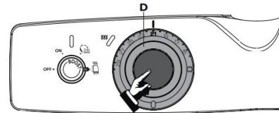
Затем верните внешний диск колесика в исходное положение. Устройство начнет менять температуру до значения 20 °C.
