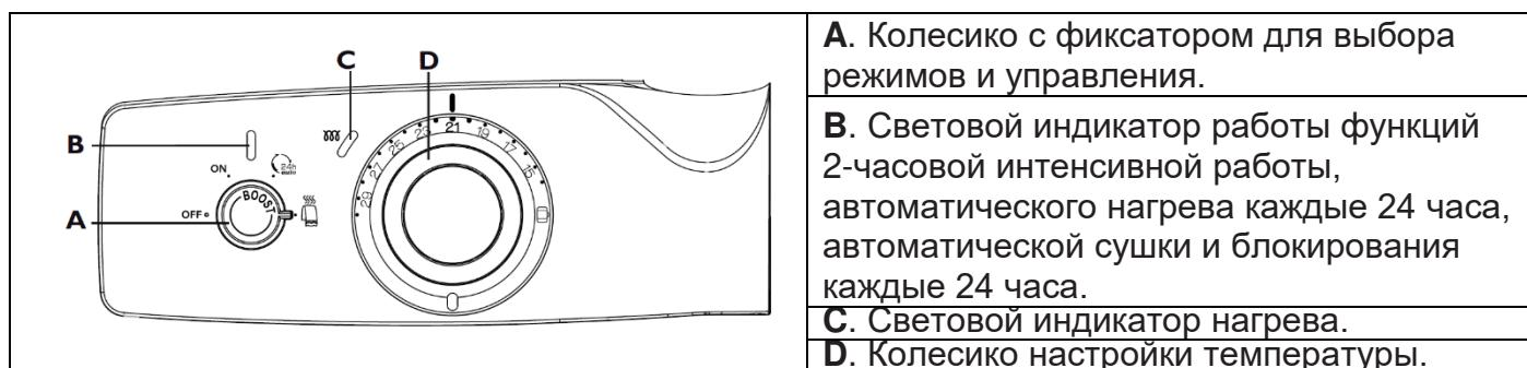
Включение и установка правильной температуры нагрева. Устройство предназначено для нагрева и создания комфортной среды в ванной комнате.
