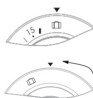
Поверніть зовнішній диск регулятора D, утримуючи центральну частину. Поверніть зовнішній диск таким чином, щоб поділка була розташована навпроти значка . Потім поверніть зовнішній диск регулятора у вихідне положення.
