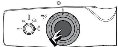
утримуючи його центральну частину. Встановіть зовнішній диск регулятора навпроти значення температури, що відображається на термометрі (позиція можна змінювати в діапазоні від -3 °C до +3 °C). Потім поверніть зовнішній диск регулятора у початкове положення. Пристрій почне змінювати температуру до значення 20 °C.
