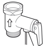
Під'єднайте до зливного шлангу
