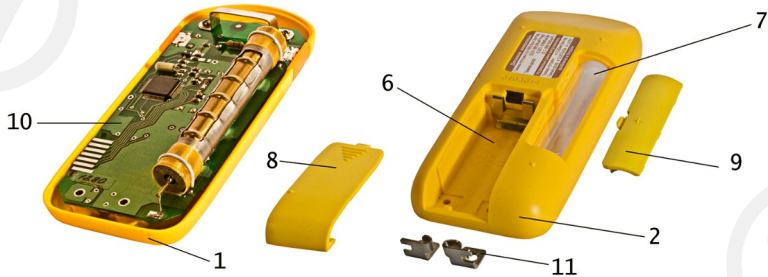
Рисунок А.2 - Вигляд ззаду зі знятою нижньою накривкою
