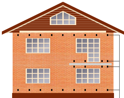
РОЗМІЩЕННЯ ВЕНТИЛЯЦІЙНО-ВОЛОГОВІДВІДНИХ ОТВОРІВ НА ПОВЕРХНІ ФАСАДУ
